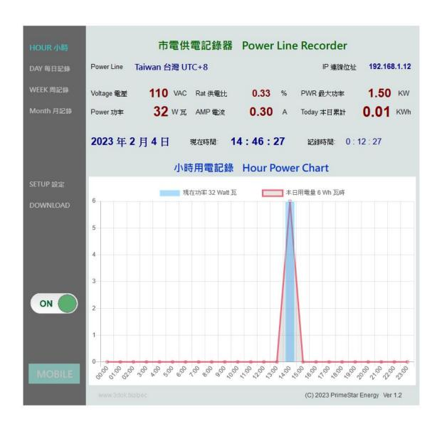
> 首頁 HOME: 本日發電分析圖 Daily Power Chart 顯示本日小時之電力發電統計圖, 藍色柱狀圖為 Power 瞬間功率 Watt 瓦, 紅色曲線為 Power Sum 累計功率 Wh 瓦時計.
